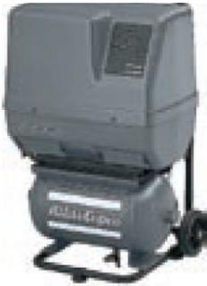
Kompressoraggregat montiert auf einem innen mit Epoxy beschichteten 20-Liter-Luftbehälter (CE/AS1210 für 50 Hz, ASME für 60 Hz), einschliesslich Regelung, Sicherheitsventil, Druckregler, geregeltem Auslassventil, Manometer und fahrbarem Rahmen. Bei 3-Phasen-Aggregaten ist ein Überlastschutz vorhanden. Eine komplett schallgedämpfte und mobile ölfreie Kompressoranlage.
